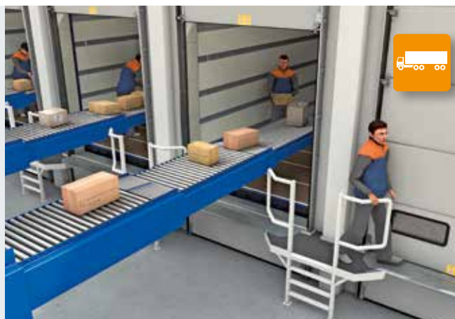
Для погрузки на грузовой автомобиль и сменные контейнеры секция цоколя со служебным мостиком остается на полу при открытых воротах
